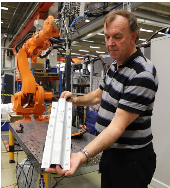
Bildtext: Jan Skogsmo med lättviktsbalk i Hybrix™ fogad med PER-PlugElement Riveting.
